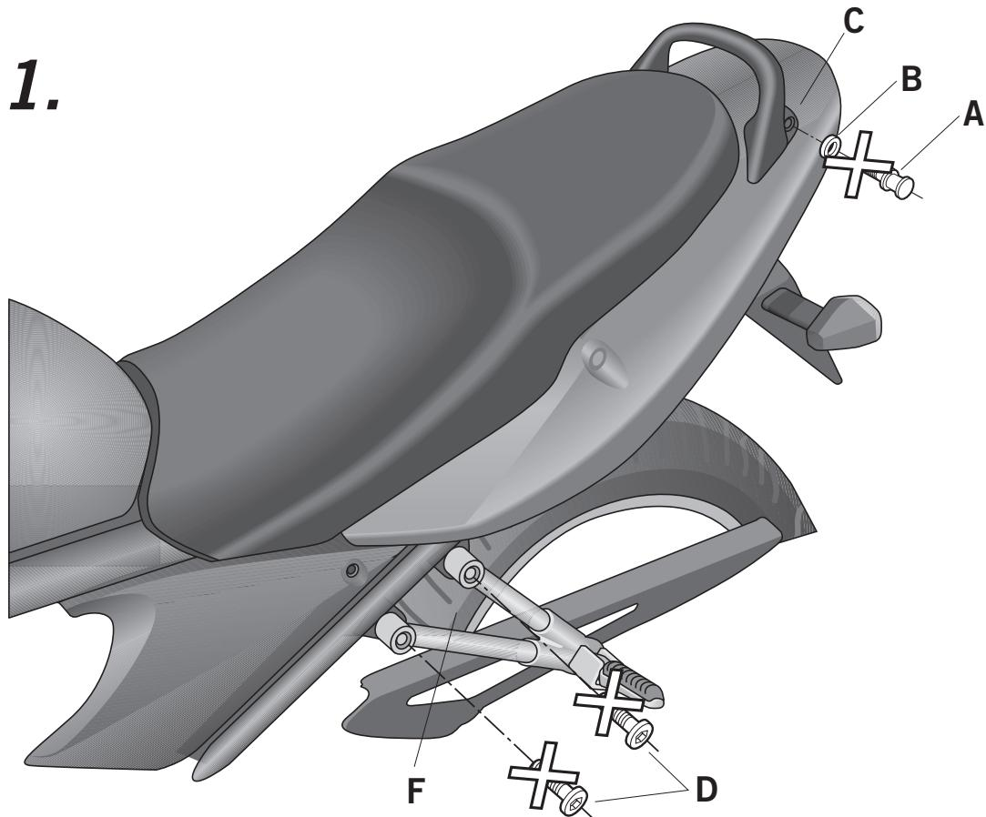
Desmontar y desestimar los tornillos (D) de las estriberas en zona (F).
