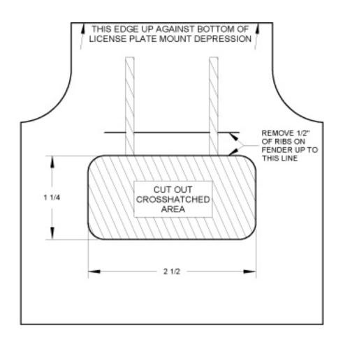
CUT OUT & LAY OVER INSIDE OF REAR FENDER
