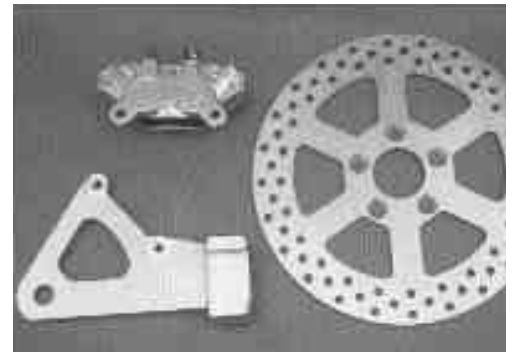
FX BRAKE SYSTEM: PN 1268-0059 11.5" X .275" ROTOR: PN 0131-1518
