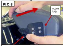
POSITION THE BRACKET OVER THE THREE STUDS BETWEEN THE BACKREST PAD AND LID
