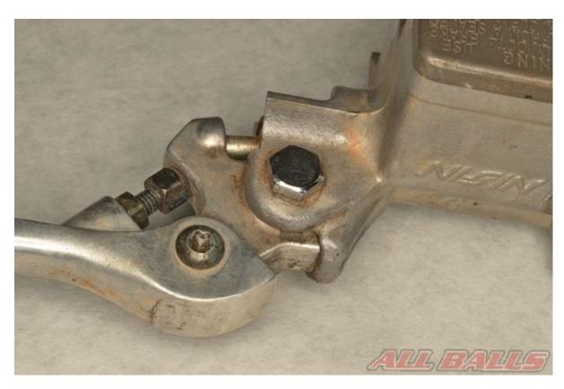
Remove the brake lever pivot bolt.
